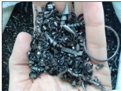
Figura 5 - Cavacos utilizados no processo Fenton Heterogêneo.
